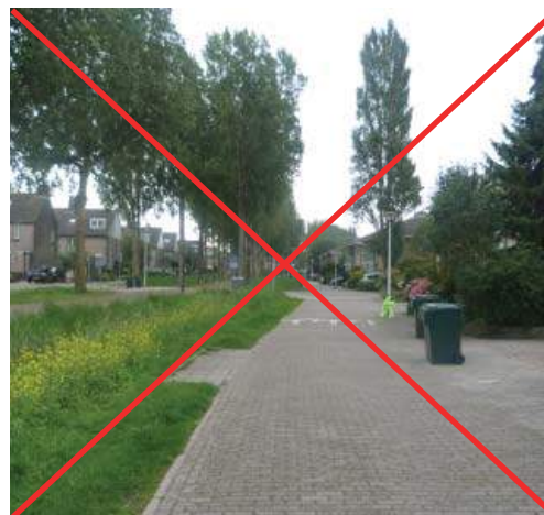
havens in groenstroken uithakken om rolcontainers 1 dag in de week te plaatsen is onwenselijk. De ruimtelijke continuïteit wordt hiermee verstoord. Bestaande trottoirs zo veel mogelijk gebruiken. Indien noodzakelijk een parkeerplaats opheffen.
